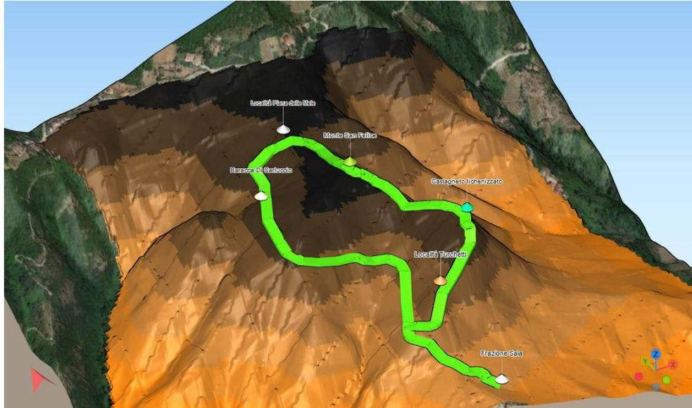
Modello 3D del percorso realizzato con QGIS 3.16 a partire dal DEM a 10 mt. Fornito da Tinitaly del Monte S Felice
